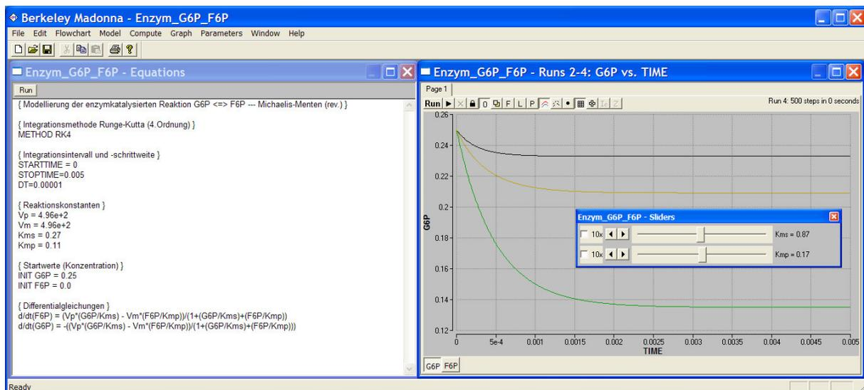
Die Betrachtung des entsprechenden offenen Systems, d.h. unter konstantem Zufluß von G6P und Abfluß von F6P funktioniert ganz analog. Dazu wird die DGL für G6P um einen Term  $+j_{in}$ , die DGL für F6P um einen Term  $-k_{out}[F6P]$  erweitert. Die Durchführung der Simulation des offenen Systems in Abhängigkeit von Stärke des Zuflusses / Abflusses bleibt dem Leser überlassen.
